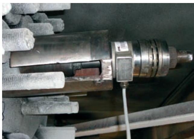
Rys. 7. Widok zainstalowanych elementów pomiarowych na głowicy zakotwienia czynnego
